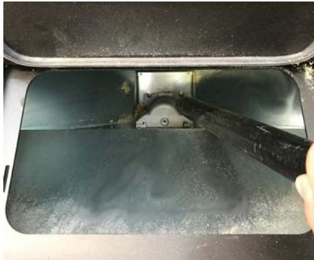
Fig. 33 - Limpieza depósito y coclea
